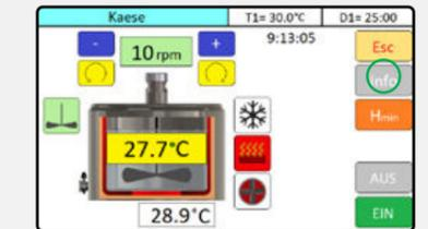
**Module zur Auswahl der Heizleistung.** Hier steht eine Auswahl an Leistungseinstellungen zur Verfügung, die besonders bei der Verarbeitung unterschiedlicher Mengen nützlich sind. (Zusatzrüstung).
