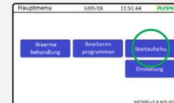
**Energieeffizient, verringert Kosten, spart Zeit.** Eine Startverzögerungsfunktion ermöglicht die Kühlung der Milch über Nacht (wenn der Strom billiger ist) und es kann ein gewünschter Zeitpunkt für den automatischen Start des thermischen Behandlungsprozesses eingestellt werden.
